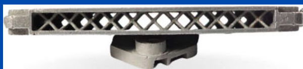
Пластина с сетчатым заполнением Сталь 12Х18Н10Т
