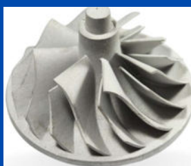
Компрессор ТРД Алюм. сплав АЛ23
